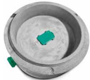
Schachtunterteil DN 1000 mit KG-Muffen DN 150 und eingebautem Reinigungsrohr
